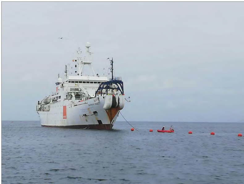
Figura 8: Barco cablero realizando el aterrizaje de cable
