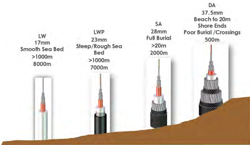
Figura 27: Protección de cable en función de las condiciones de uso.
